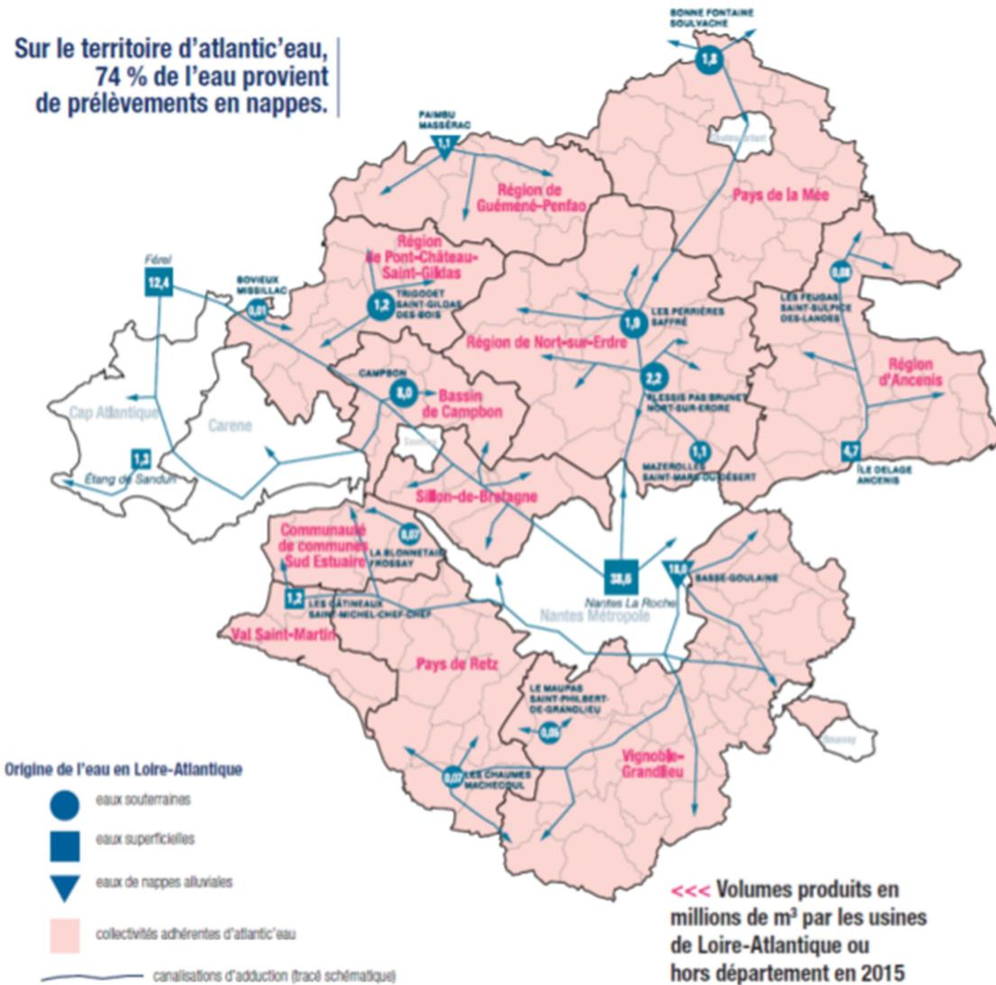
Figure 16 : Schéma de distribution de l'eau potable à l'échelle du département de la Loire Atlantique (Source : Atlantic'eau 2015)
